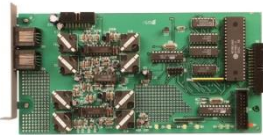
AP04P плата на 4 порта четырехпроводных системных телефонных аппаратов (СТА).
