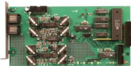
AP04P плата на 4 порта четырехпроводных системных телефонных аппаратов (СТА).
